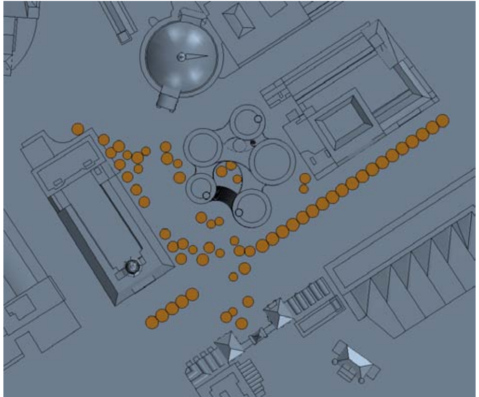
Figur 8.3 Plan over beplantningen som indlagt i CFD-modellen.
