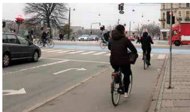
Fremført cykelsti, Søtorvet/Frederiksborggade
