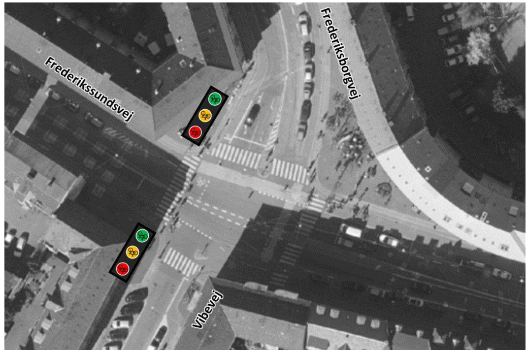
Figur 8: Principskitse af løsningsforslag med etablering af cyklistsignaler for cyklister på Frederiksborgvej. Cyklister på Frederiksborgvej afvikles i separat fase fra biltrafikken på Frederiksborgvej. Denne fase kan samordnes med cyklistsignalet på Vibevej.
