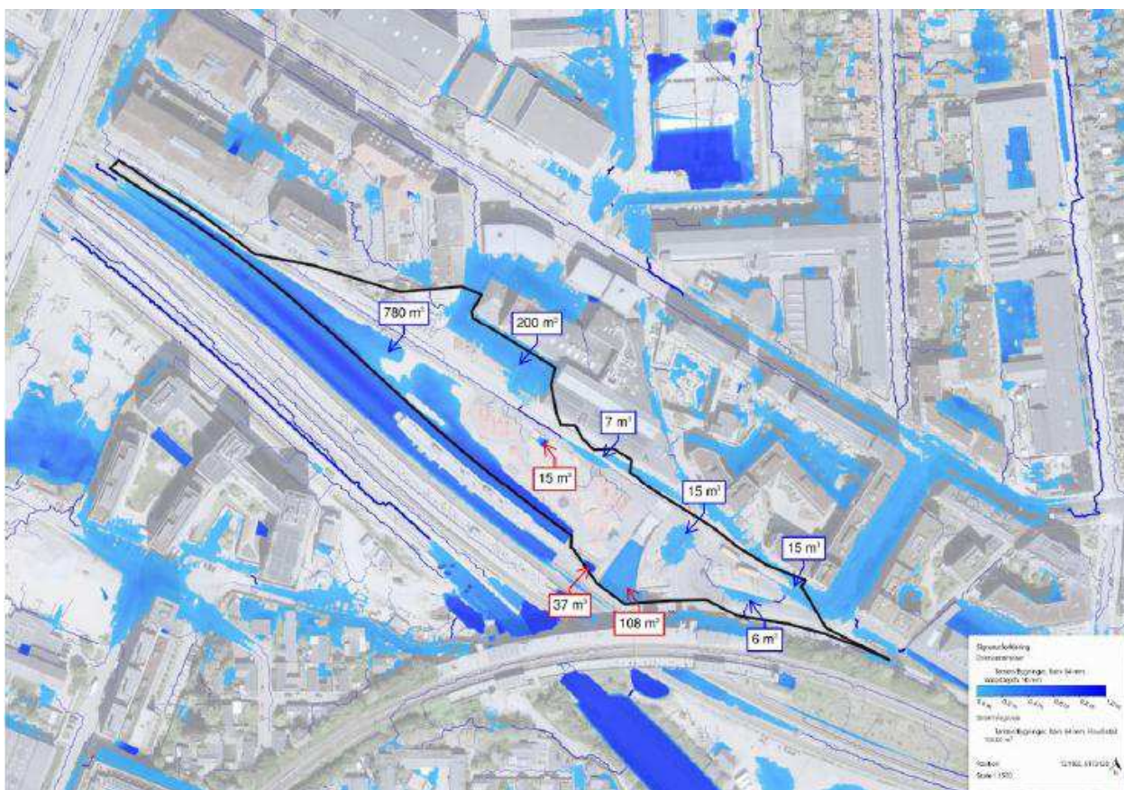
Figur 19.2: Scalgoanalyse af eksisterende forhold for ekstremregn /Bilag 9/.
