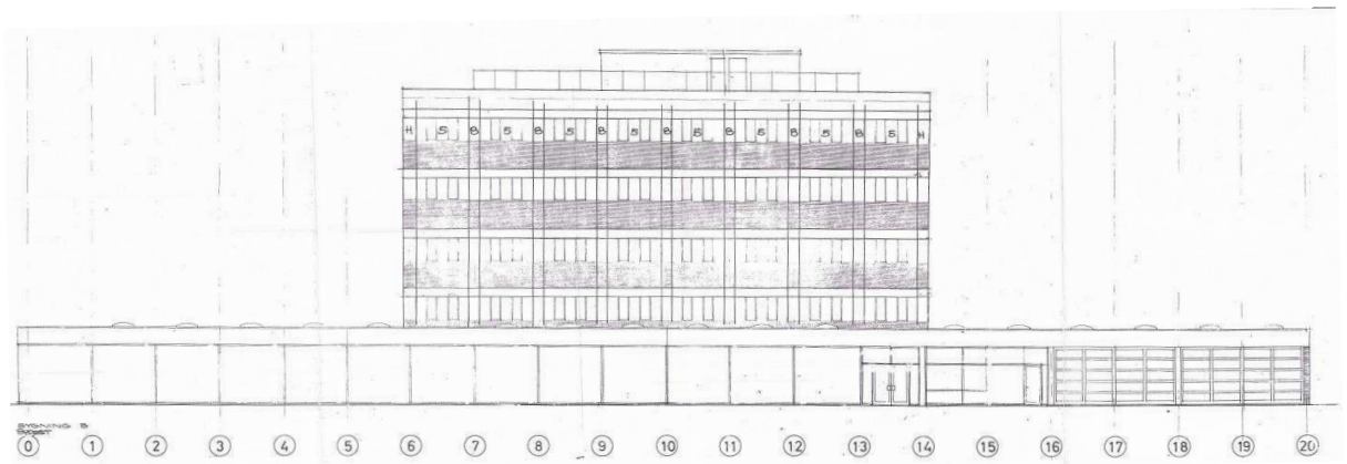
Oprindelig Facade med fuldglas fra sokkel til overligger i stueplan Service-station
