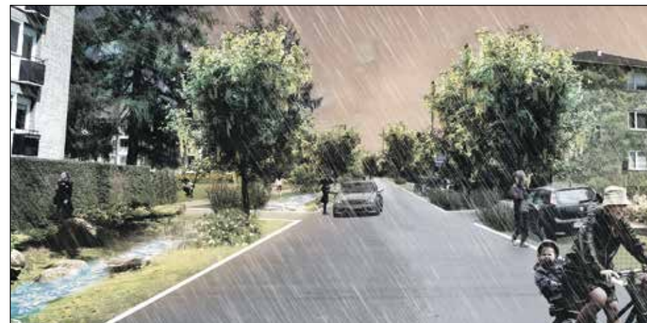
Figur 19. Eksempel på løsning i tæt lav bebyggelse: Kirsebærhaven ved hverdagsregn. Render opsamler overskydende regnvand og leder det videre.
