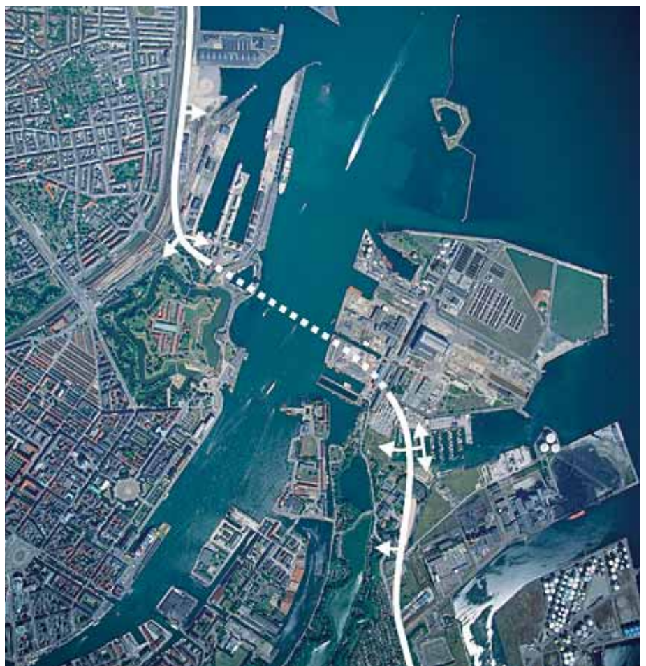
Linjeføring for kort sænkettunnel med tilslutningsanlæg
