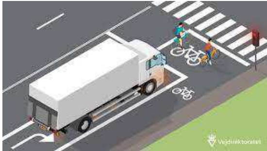
Figur 11: Principtegning af en cykelboks (kilde: Vejdirektoratet)
