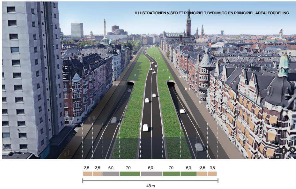
Eksempel på til- og frakørselsramper i byrummet
