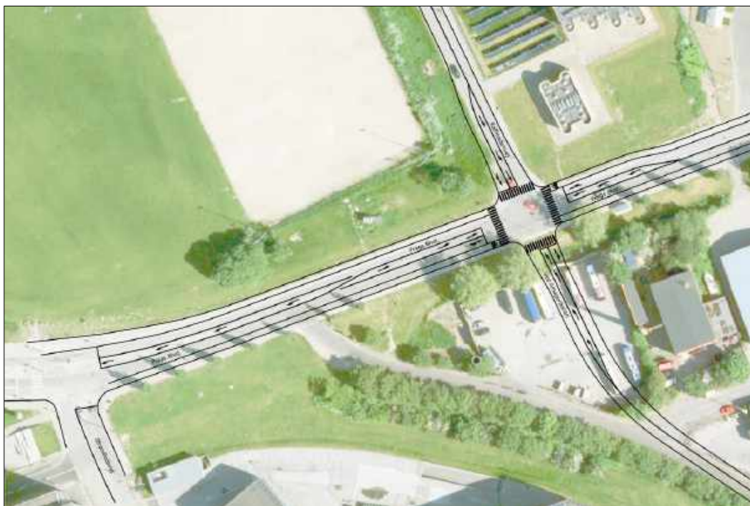
Figur 3. Principskitse af udbygningen af krydset Prags Boulevard/Raffinaderivej fra 2015. 1 OBS! Hovedprojektet, der skal stå færdigt inden udgangen af 2019, adskiller sig fra den viste principskitse.
