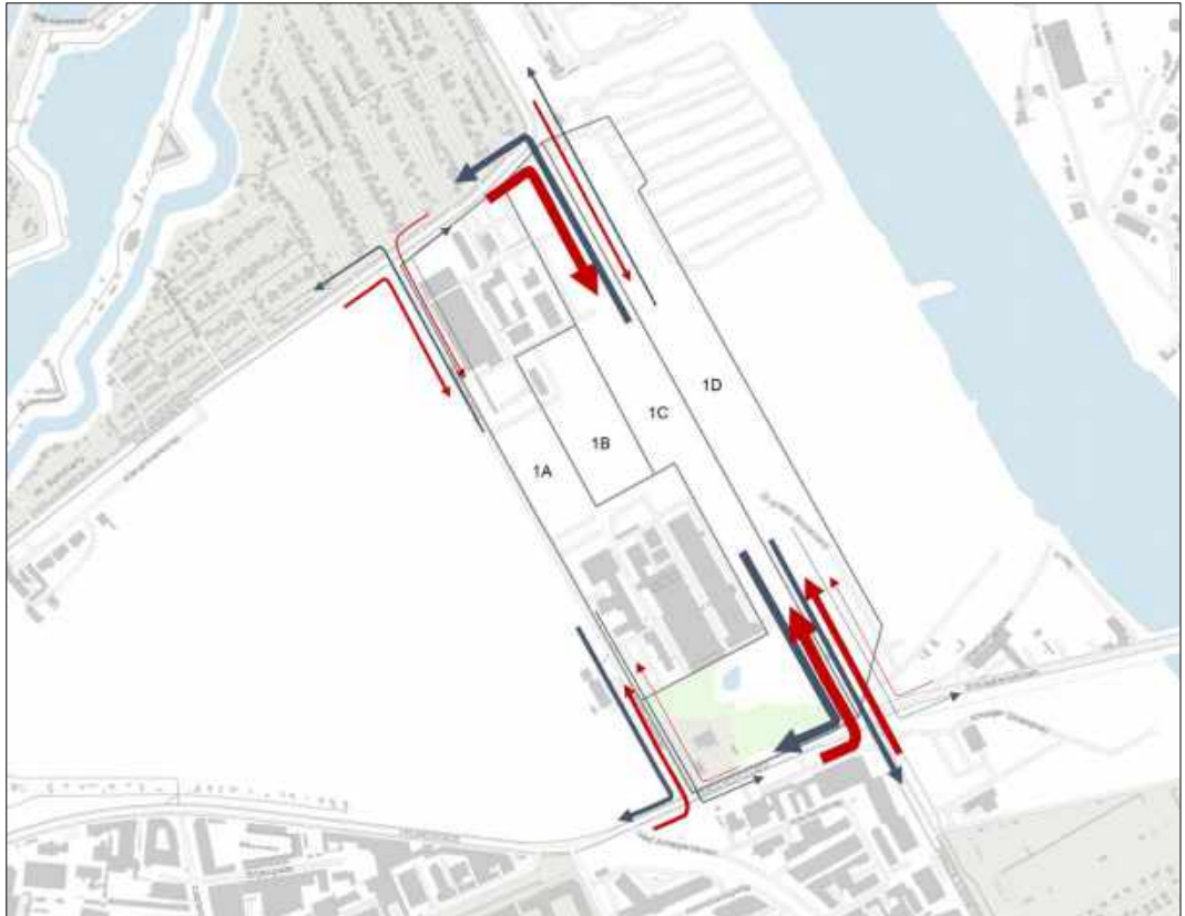
Figur 11. Vurderet fordeling af trafikstrømme til (rød) og fra (blå) et fuldt udbygget Kløverkvarter fase 1A-D i en eftermiddagsspidstid. Tykkelsen af stregerne indikerer relative forskelle i trafikmængderne. Den største trafikstrøm til Kløverkvarteret er venstresvingende fra Prags Boulevard til Kløverbrogade, hvor der er estimeret knap ca. 350 bilture i eftermiddagsspidstimen.
