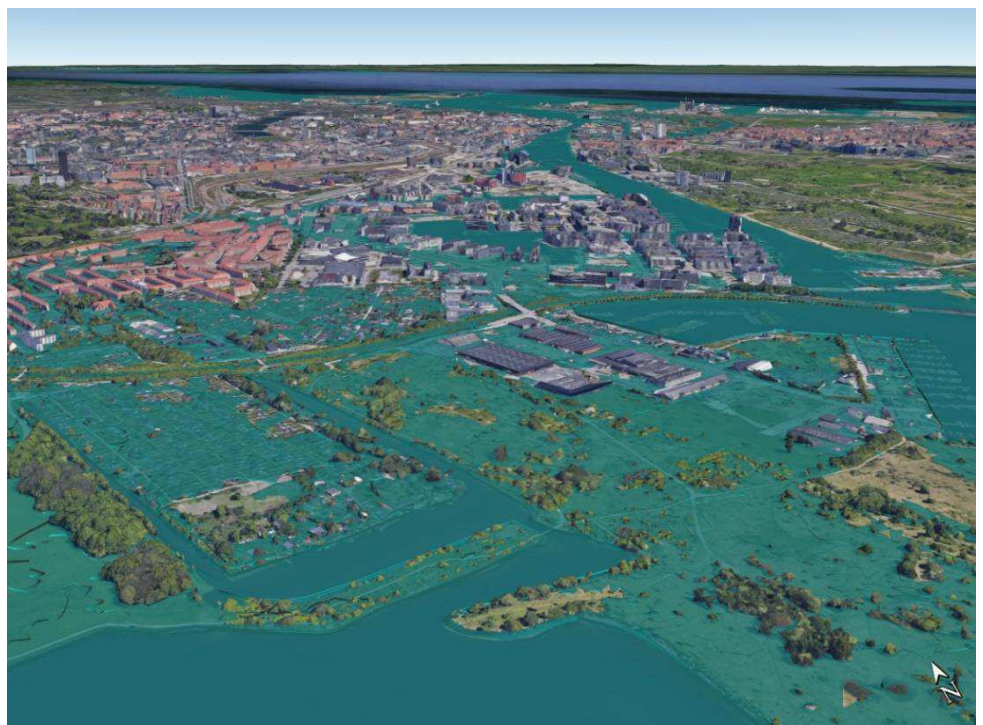
Figur 18: Visualisering af Sydhavn set fra Kalveboderne 14 timer efter en mulig stormflod fra syd på kote 3,84 (Google Earth)
