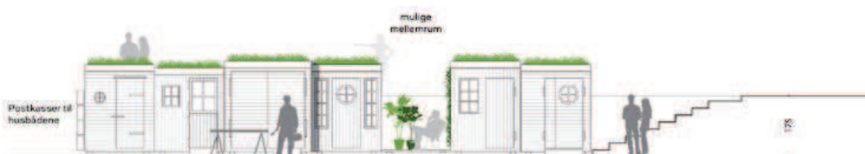
Eksempel på udformning af bådskure med horisontal og vertikal bræddebeklædning samt begrønning af tagene. Holscher Arkitekter.
