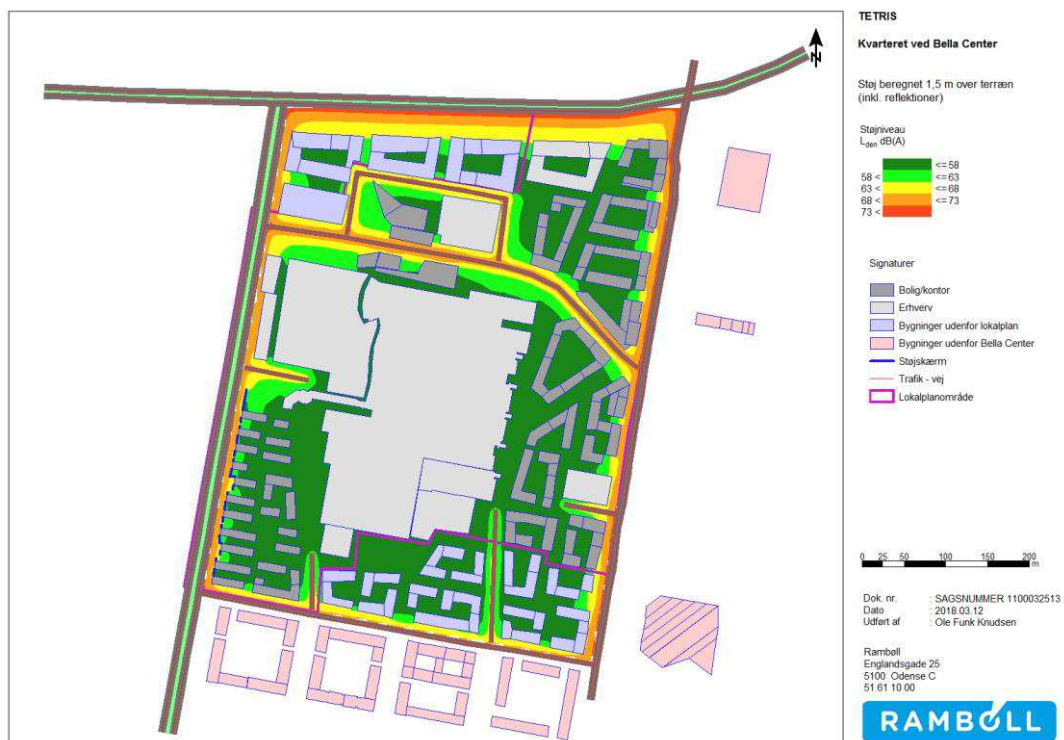
Figur 5-4. Beregnede støjbelastninger på terræn i højden 1,5 m inklusive refleksioner. Grænseværdi på 58 dB gældende for udendørs opholdsarealer er angivet med den mørkegrønne farve.
