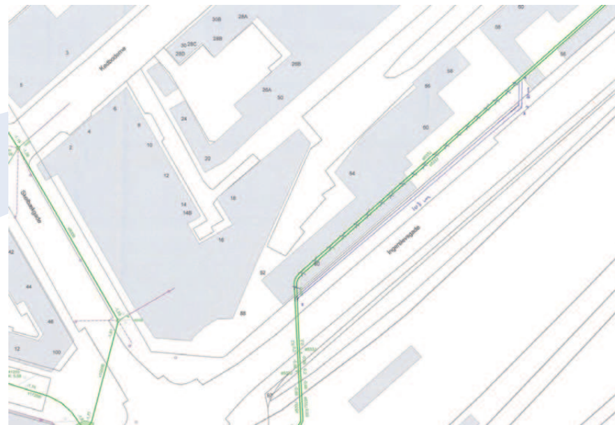
Figur 3; Omlægning af afløbsstrykledning
