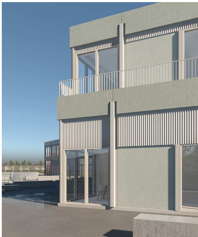
Udformningsprincipperne for de nye bygningers facader med underinddeling i forskellige delementer, der tillader fleksibilitet ift. funktionen bag (Illustration: Nøhr & Sigsgaard Arkitektfirma).
