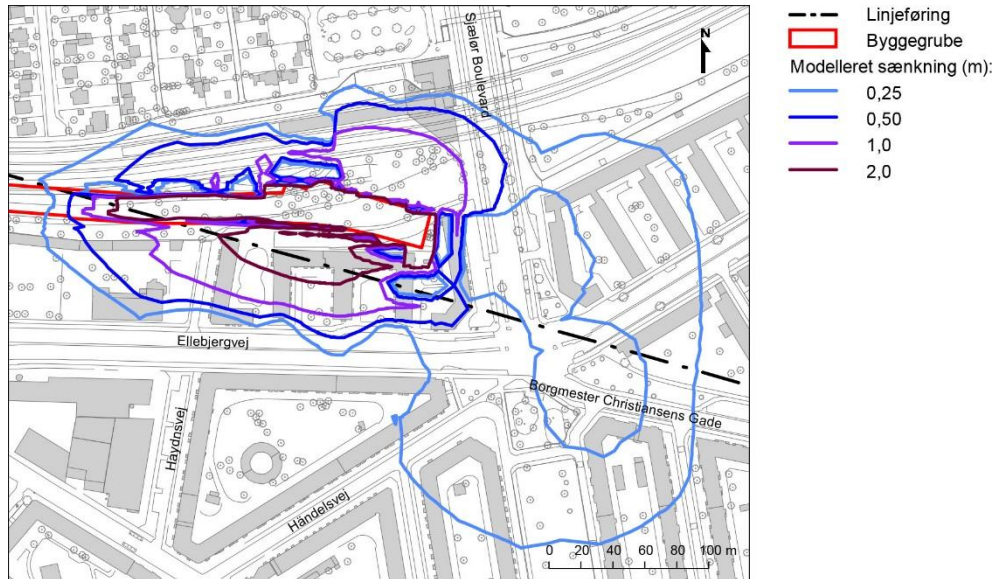
Figur 15-14 Beregnet sænkning i kalkmagasinet ved grundvandssænkning for afgrænsningskammer og rampe ved Haydnstvej, med vægge til 2 m under bund udgravning og ca. 90 % reinfiltration
