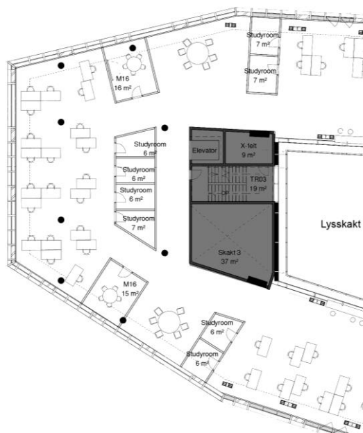
Figur 2A. Udsnit af 2. sal af det bearbejdede projekt med markering af kerne til teknik og adgangsforhold (ca. 90 m 2 pr. etage). C F Møller
