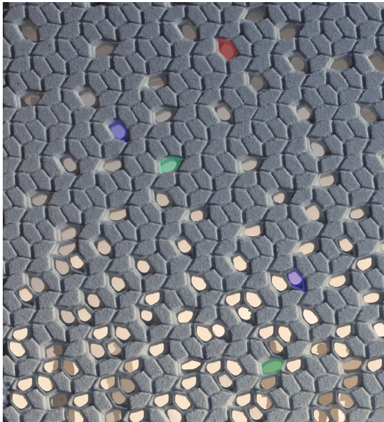
Figur 2: Facadeudsnit, der viser princip for facademønsteret, der definerer et geometrisk mønster med lysåbninger (Illustration Henning Larsen Architects).
