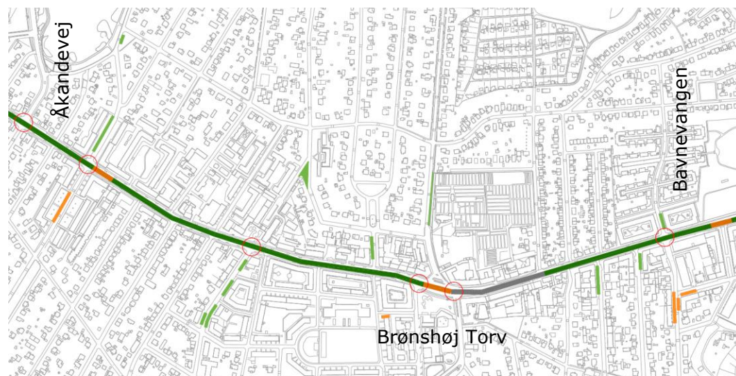
Figur 5: Eksempelstrækning på Frederikssundsvej gennem Brønshøj mellem Bavnevungen og Åkandevej. På begge sider af letbanens tracé er de udvalgte lokaliteter for relokalisering af parkering vist som enten grønne eller orange områder. Signaturforklaring:
