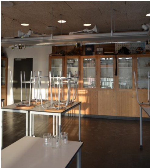
Eksempel på faglokale/laboratorie med installationer i loft der giver mulighed for fleksibel indretning, Nørrebro Park skole.
