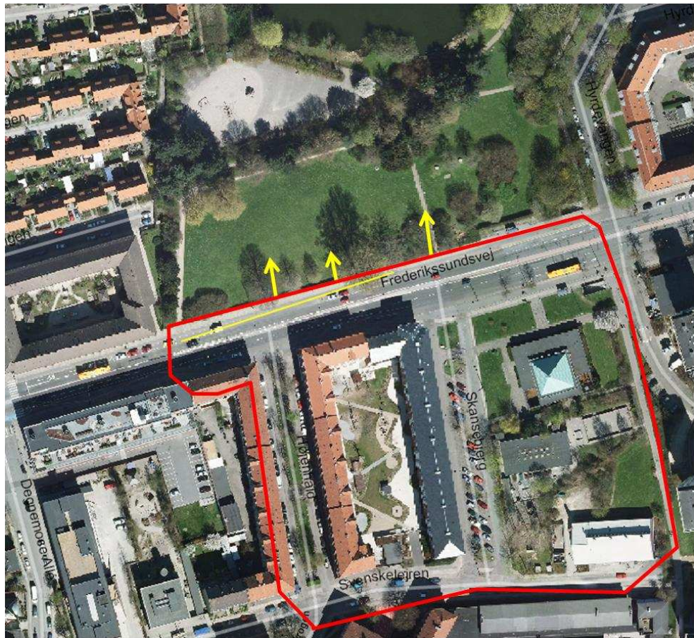
Figur 12. Opland til Brønshøjparken med flere udledningspunkter
