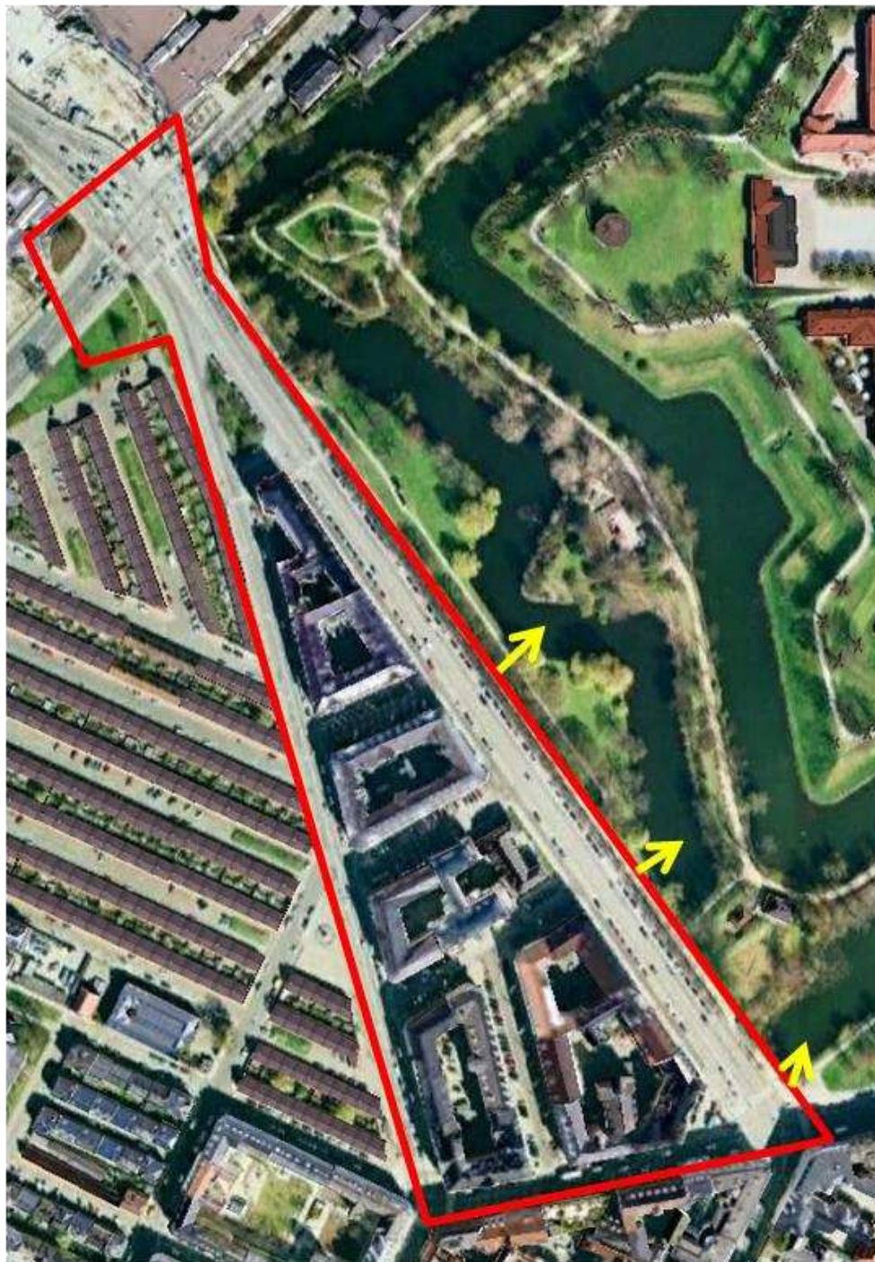
Figur 15 Opland til Kastelsgraven med flere udledningspunkter
