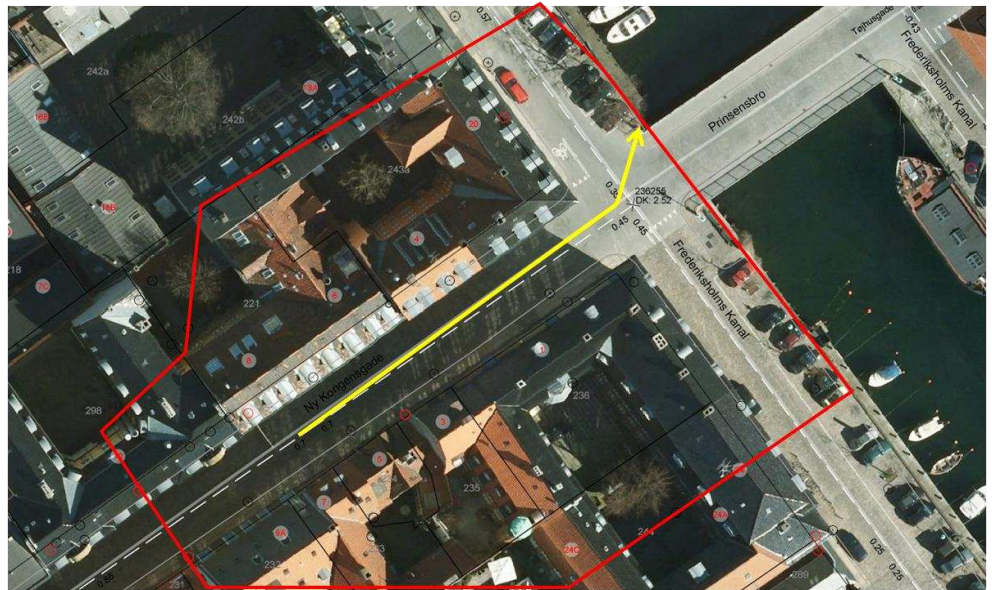
Figur 8 Opland til Frederiksholms Kanal med udledningspunkt
