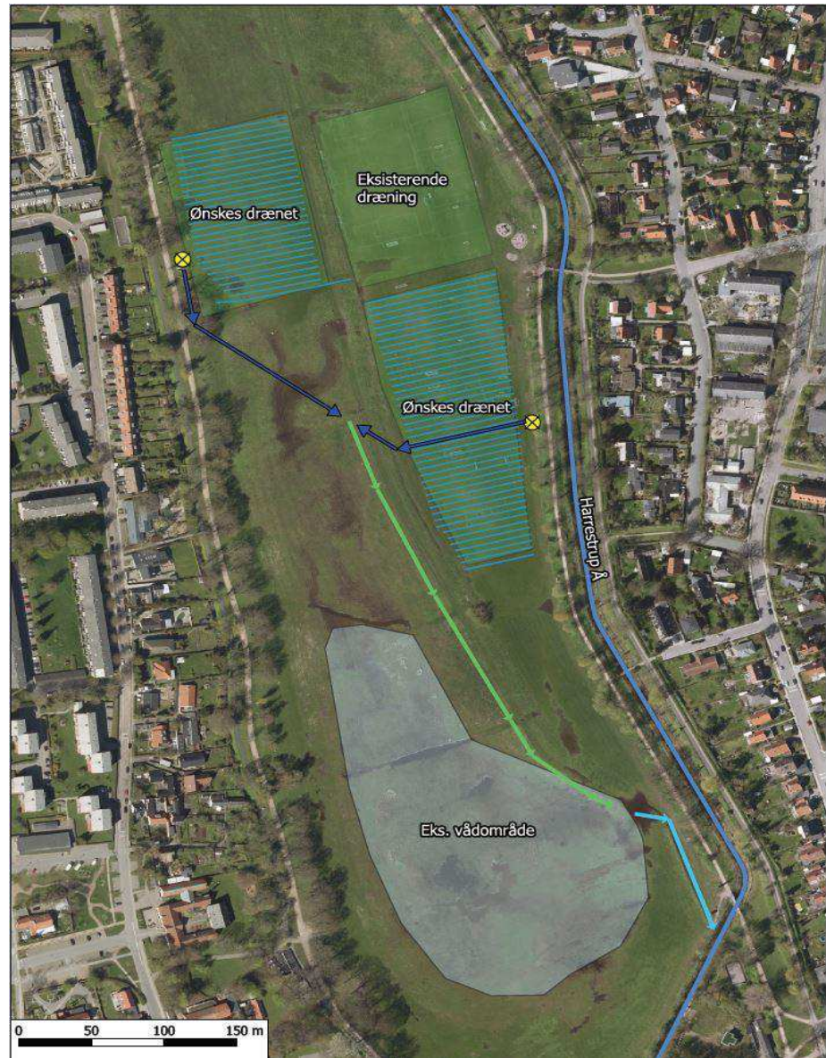
Figur 3.5: Forslag til fremtidig drænvands afledning.
