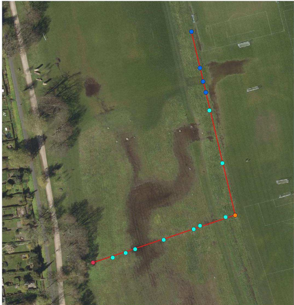
Figur 2.18: Forløb af drænsystem fra kloak (ved "Ventilbrønd") og op til den drænedede fodboldbane. Indmålt ved tv-inspektion og spuling den 22. marts og 5. april 2018.
