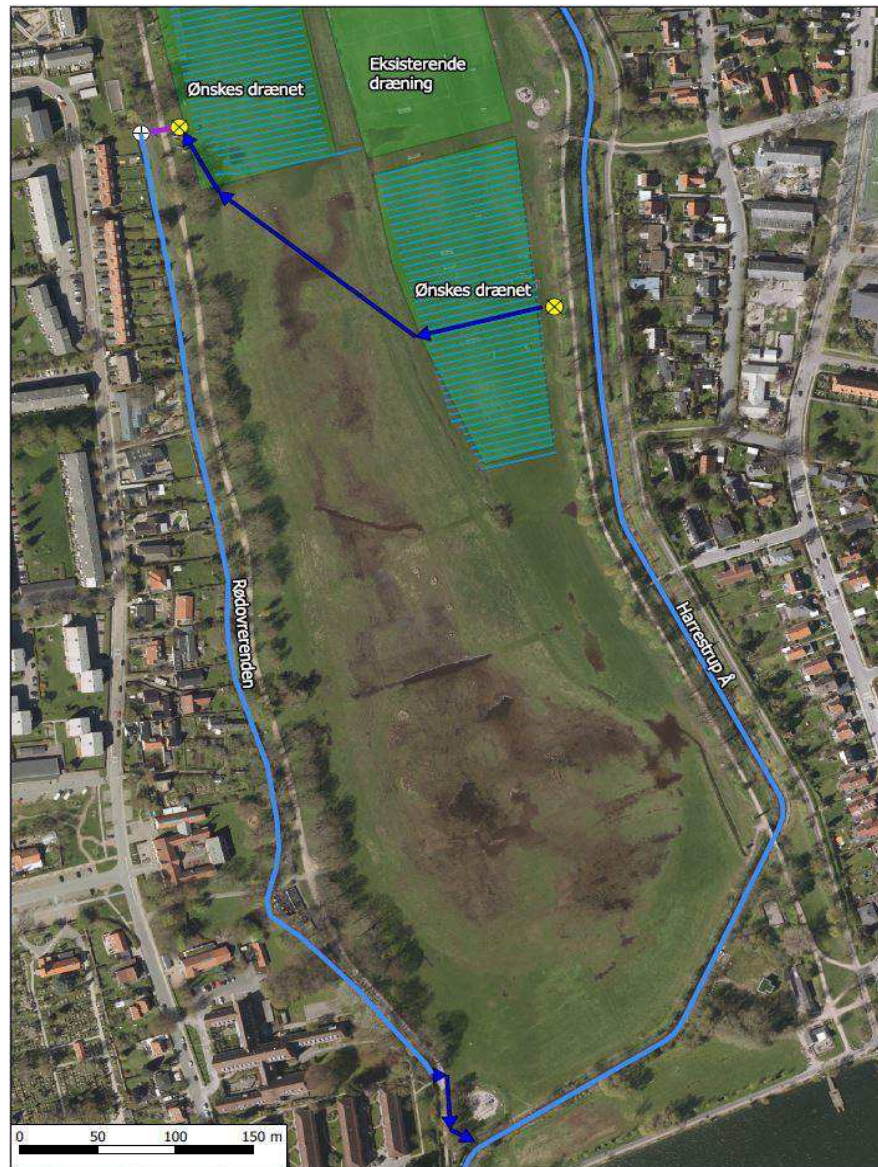
Figur 3.3.4: Forslag til fremtidig drænvands afledning.
