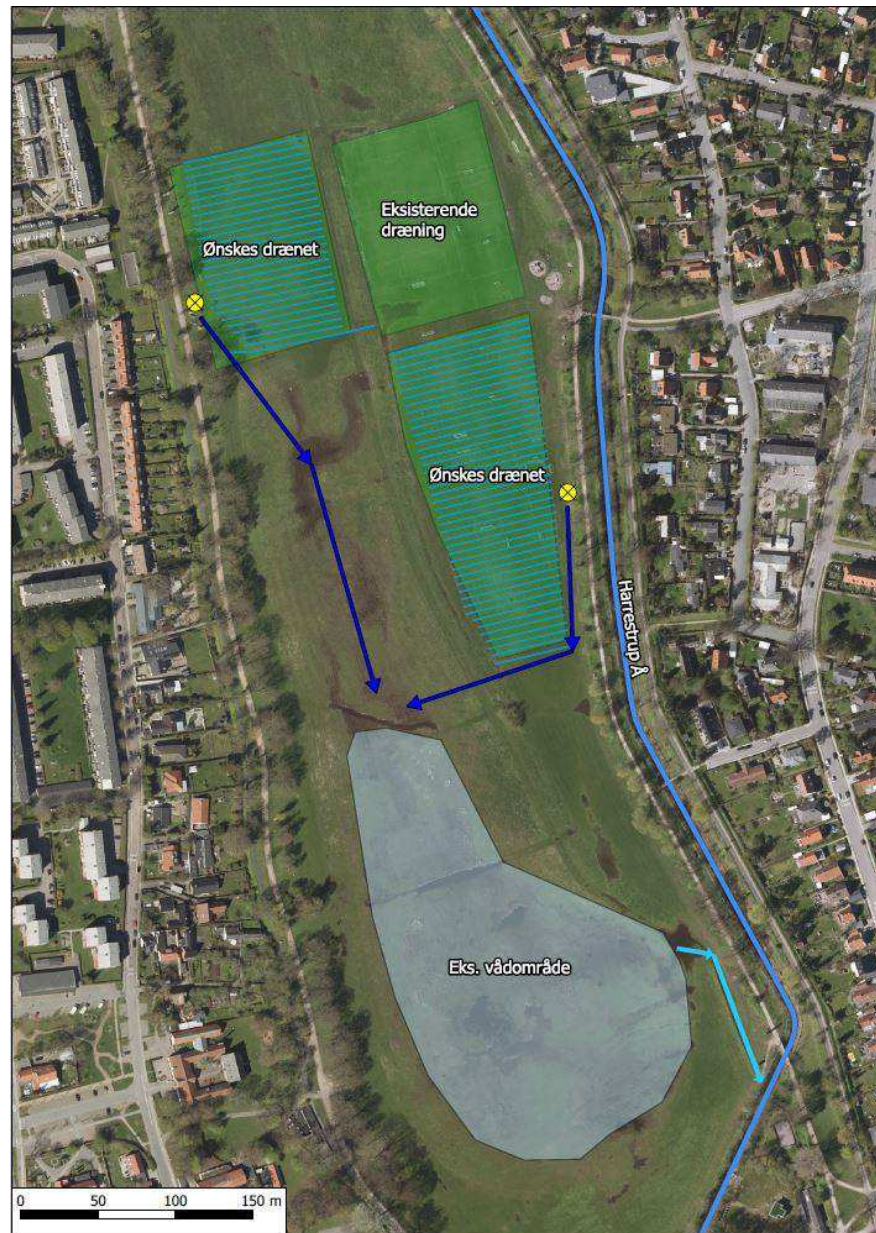
Figur 3.6: Forslag til fremtidig drænvands afledning.
