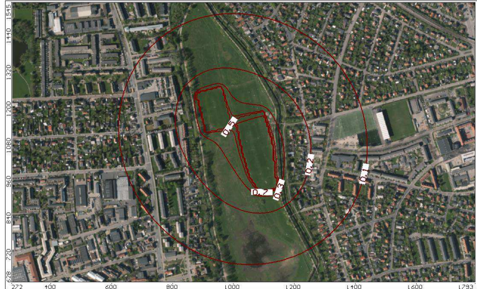
Figur 2.14: Sænkning af terrænnært grundvandsspejl, (m) ved høje K-værdier for lag 1 og 2.
