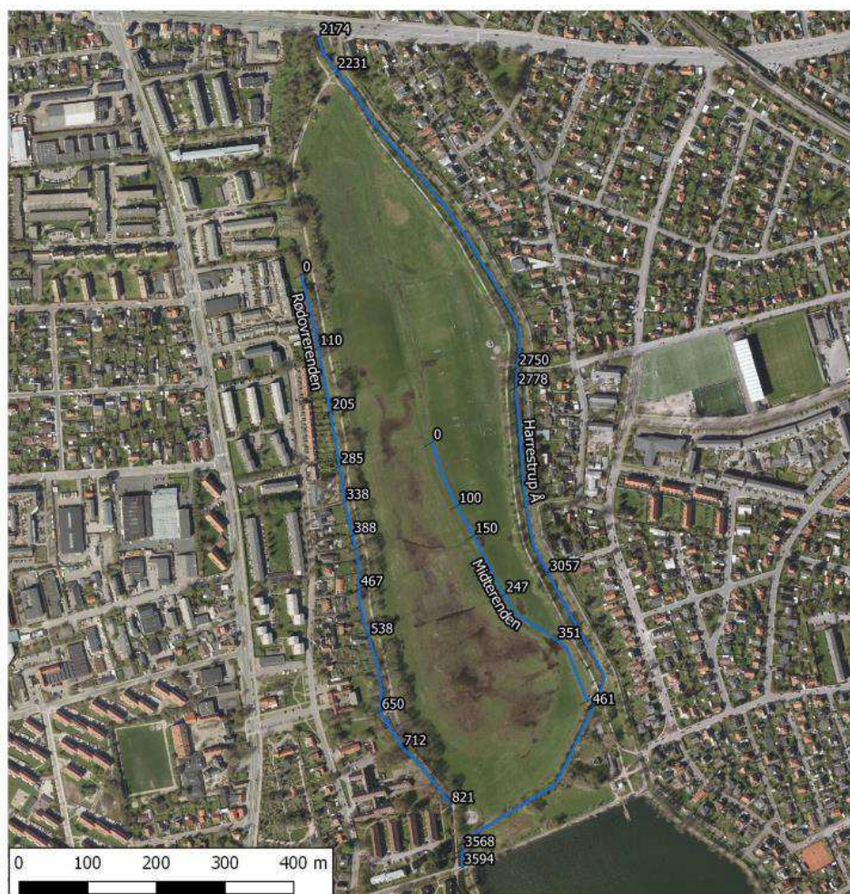
Figur 2.5: Stationering for de tre vandløb der er opmålt i marts 2018.
