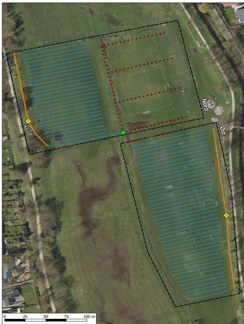
Figur 3.3: Forslag til fremtidigt afvandingsystem.
