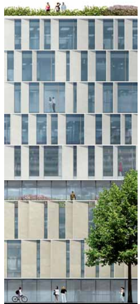
Skitse af facadeudsnit på Nordfløjen med tilbagetrukket åben glasfacade i stueetagen. Herover en tungere og mere lukket Base, og derpå en let og åben etage med glasfacade og øverst en Overbygning i et lettere og mere åbent udtryk end basen. På taget er vist beplantning og opholdsmuligheder. Basen forventes anvendt til patientbehandling og overbygningen fortrinsvis til sengestuer. Illustrationer fra rådgiverteamet.
