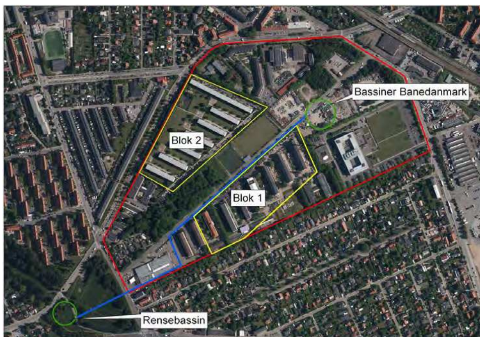
Trace for regnvandsledning og frakobling af blokke
