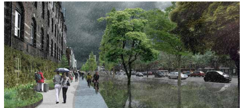
Fig. 11b Ved et kraftigt skybrud håndteres regnen ved at midterrabatten og en kørebane oversvømmes. Det vil forsat være muligt både at cykle og køre bil.
