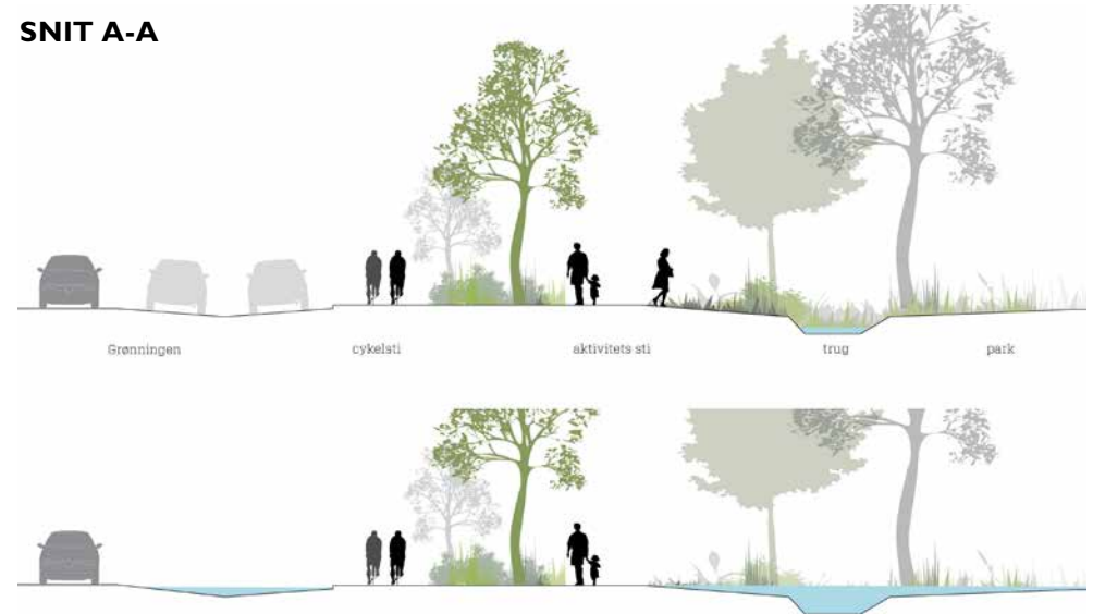
Fig. 7 Snit A-A viser, hvordan Grønningen kan se ud i en hverdagsituation (øverst) og i en ekstremregnsituation (nederst).
