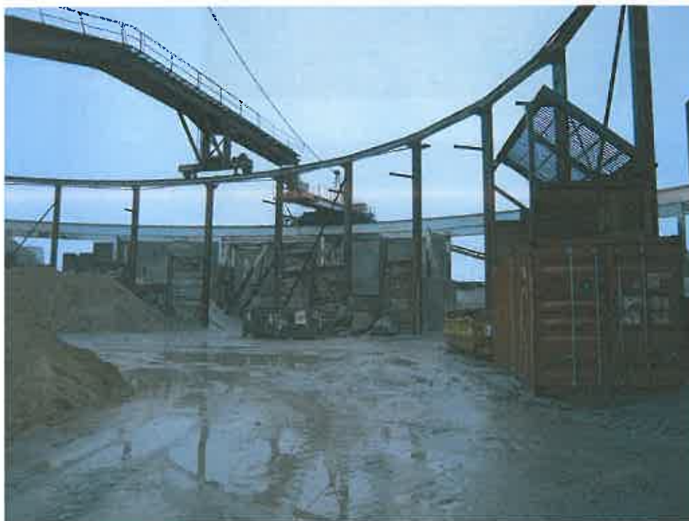
Billede 1 viser bulkanlægget indefra. Bemærk spor til transportbånd samt opdelinger til bulken.
