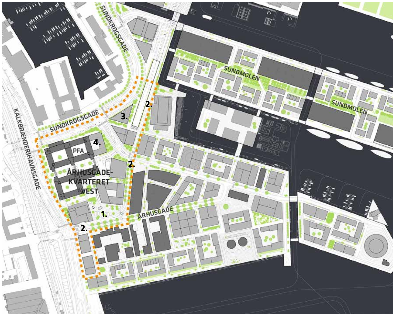
Bebyggelsesplan for Århusgadekvarteret Vest udarbejdet af COBE, SLETH, Rambøll og Polyform. 1. Metrostation ved Århusgade med cykelparkering, adgang til metro og beplantning 2. 'Det grønne Loop' med Metro og cykelsti. 3. Høj bygning. 4. Tilbygning til "PFA".
