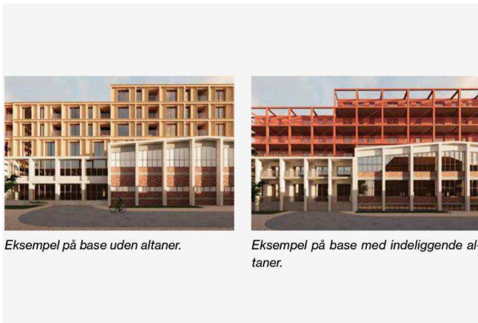
Figur 5-110 Skitser af hvordan facaderne på Værkstedet og Eftersynshallen kan udformes med ny bebyggelse bag facaderne og altaner. Eksemplet til højre kan ikke realiseres indenfor lokalplanens bestemmelser, da tegltavlerne ikke bevarer i et omfang, som opfylder lokalplanens bestemmelser. Illustration Cobe.
