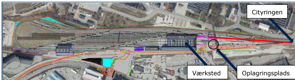
Figur 9-6. Trolje kører fra oplagingsplads med 20 km/t ind på Cityringen og tilbage igen efter udført vedligehold.
