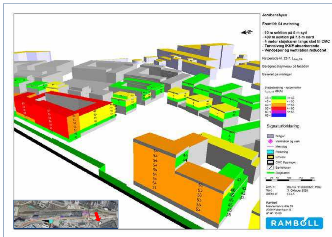
Figur 20-19. Scenarie: Reduceret støj uden overdækning. 3D opstalt af beregnet støjniveau på facaden i natperioden. Grå facader er udsat for støj med niveauer under 40 dB. Opstalten viser bygninger på sydøst siden af CMC set fra CMC området med tunnelrampen til venstre (sammenlign evt. med Figur 20-18).
