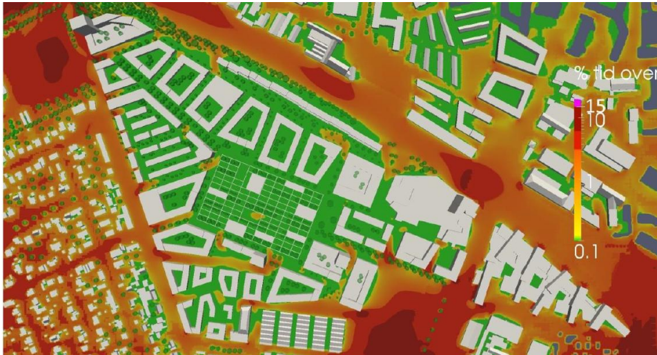
Figur 3. Vindforhold for området, beregnet med lægivende foranstaltninger i form af træer. Uddrag af vindanalyse udarbejdet af Vind-vind ApS, dateret 2014.11.05.
