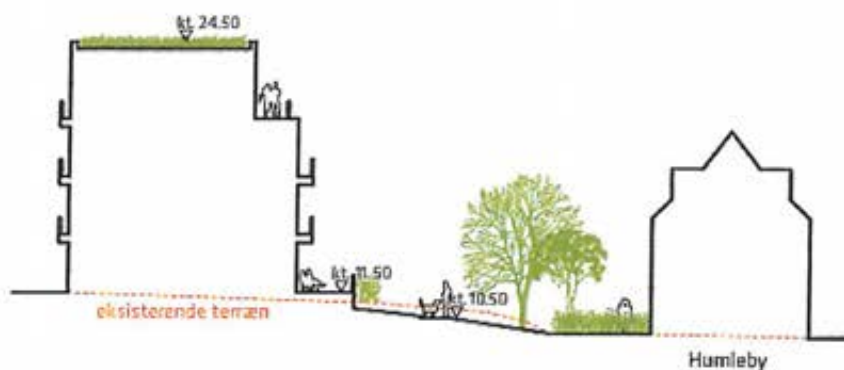
Snit 1: Nord for Humleby kan boligbebyggelsen (tv.) opføres i 4 etager ud til et grønt stiftorløb.
