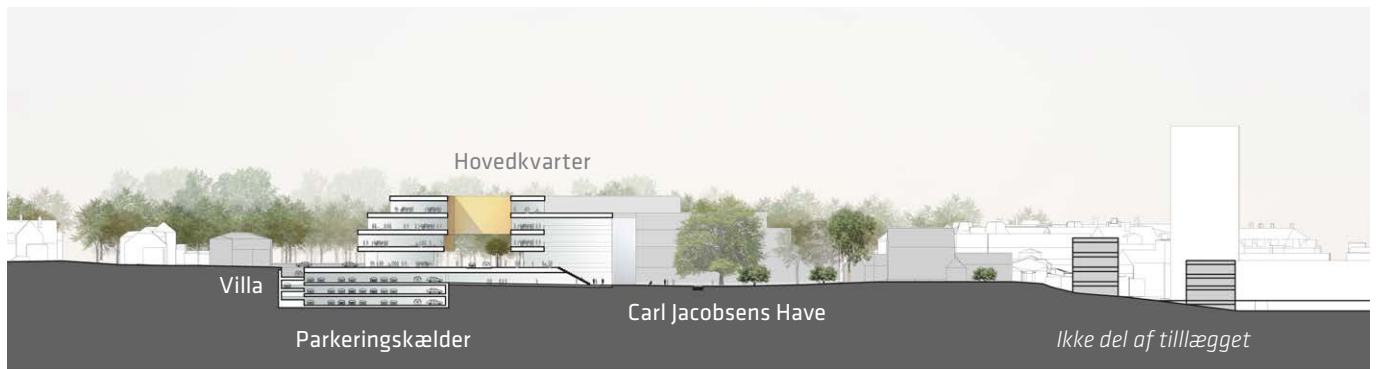
Tværsnit i Gamle Carlsberg Vej set mod nord. Hovedsædet er placeret på begge sider af og hen over vejen. Illustration: C F Møller
