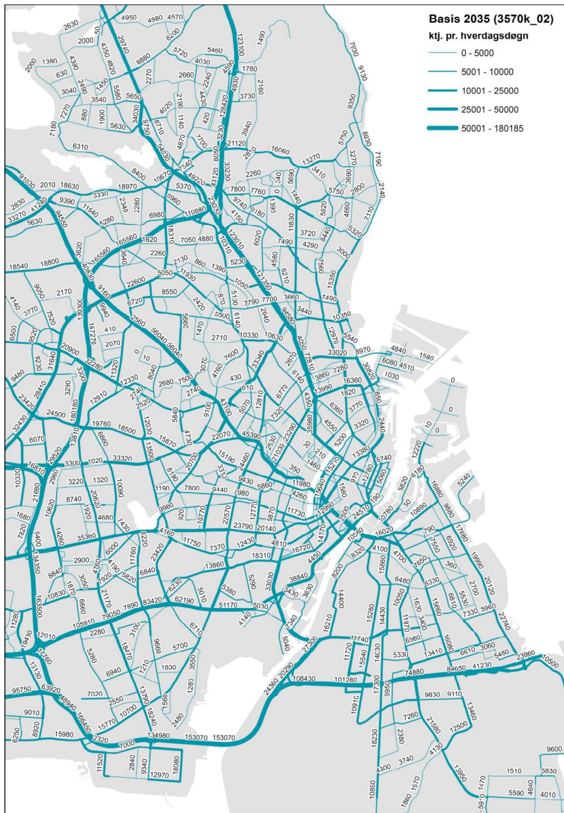
Figur 5: Trafikmodelberegning for 2035 basis - dvs. uden Østlig Ringvej - regionalt fokus (kilde: Forundersøgelsen af Østlig Ringvej)
