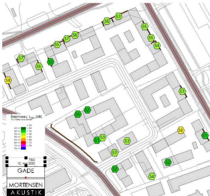
Figur 7-6. Støjniveauer på tagterrasser med 1,8 m høje støjskærme.
