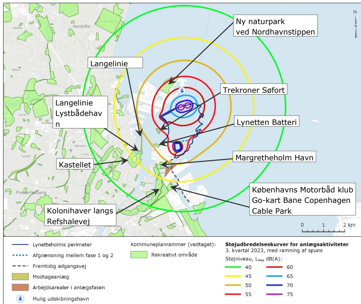
Figur 27-6. Eksempel på støjens udbredelse under anlægsarbejdet i perioder hvor der rammes i forhold til rekreative forhold i området.
