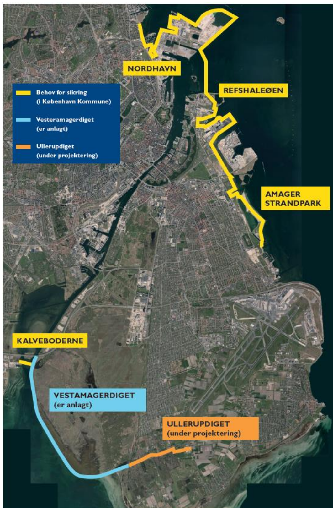
Figur 7-5 Hovedgreb for stormflodssikring i København /41/.
