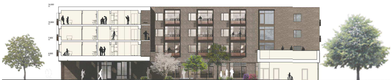
Facadeopstalt gård og port med snit i bygning mod gade og lav bygning med fællesarealer
