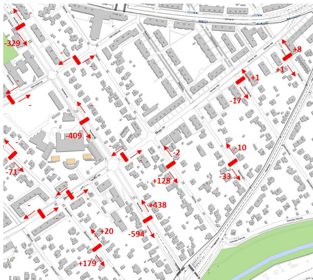
Figur 8. Forskel i trafiktal ved førtællinger 2012 og eftertællinger 2015 [ktj./12h]. Sum af personbiler og tung trafik opgjort for en 12-timers periode mellem kl. 7-19 på hverdage.
