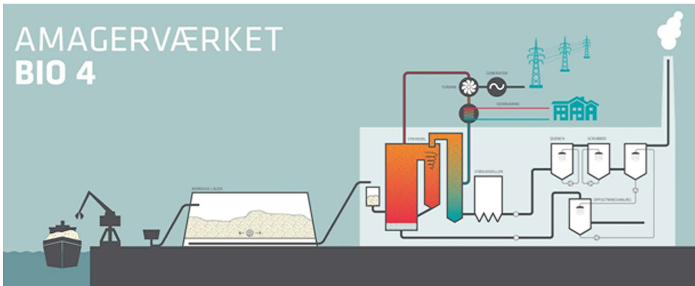
Principskitse for AMV4. Illustration af HOFOR.
