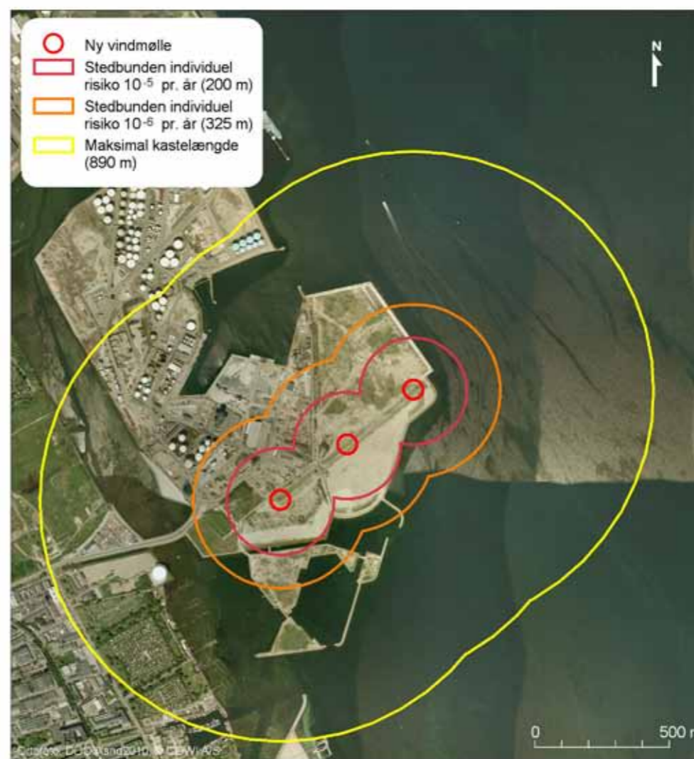
Figur 7.2 Maksimal kastelængde (nedfaldsområde) og afstand til stedbunden individuel risiko på 1 \times 10^{-6} pr. år og 1 \times 10^{-5} pr. år for 3 vindmøller med totalhøjde op til 115m.
