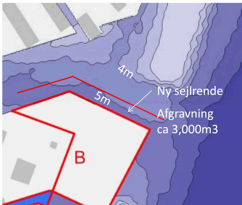
Figur 2: Vanddybdeforhold nær Enghave Brygge og ny sejlrende I forbindelse med gravningen vil der typisk ske et spild af materiale til vandsøjlen i størrelsesordenen 5 %. Dette spild vil spredes i havnen.
