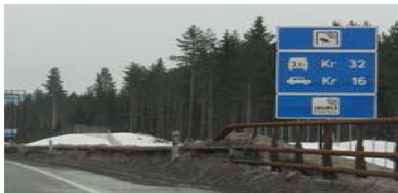
FIGUR 3.8 Eksempel på forvarsling af betalingsvej i Norge (i en løsning ved København, hvor priserne varierer hen over dagen, kan der benyttes dynamiske tavler til visning af den aktuelle pris)
