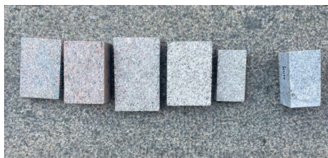
Udvalgte nordiske granittyper til belægningen.
