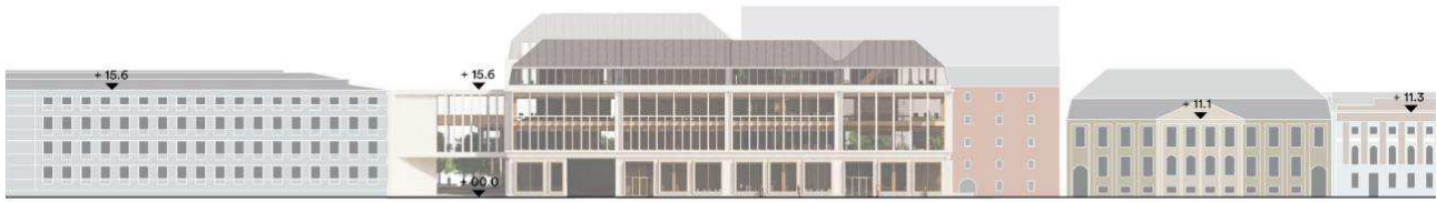
Opstalt mod Amaliegade. Illustration, der viser et eksempel på nybyggeri i overensstemmelse med lokalplanen. Illustration: Dorte Mandrup A/S.
