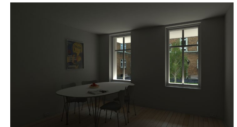
Lyset på en solskinsdag med en altan på 1,5 m over begge vinduer
