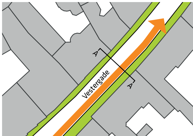
Principplan for modstrømscykelsti (orange) i det eksisterende vejprofil.
