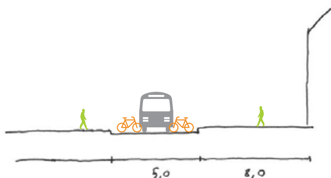
Principsnit BB for opretholdelse af spærring mellem Vestergade og Strøget – Vester Voldgade mellem Vestergade og Studiestræde.
