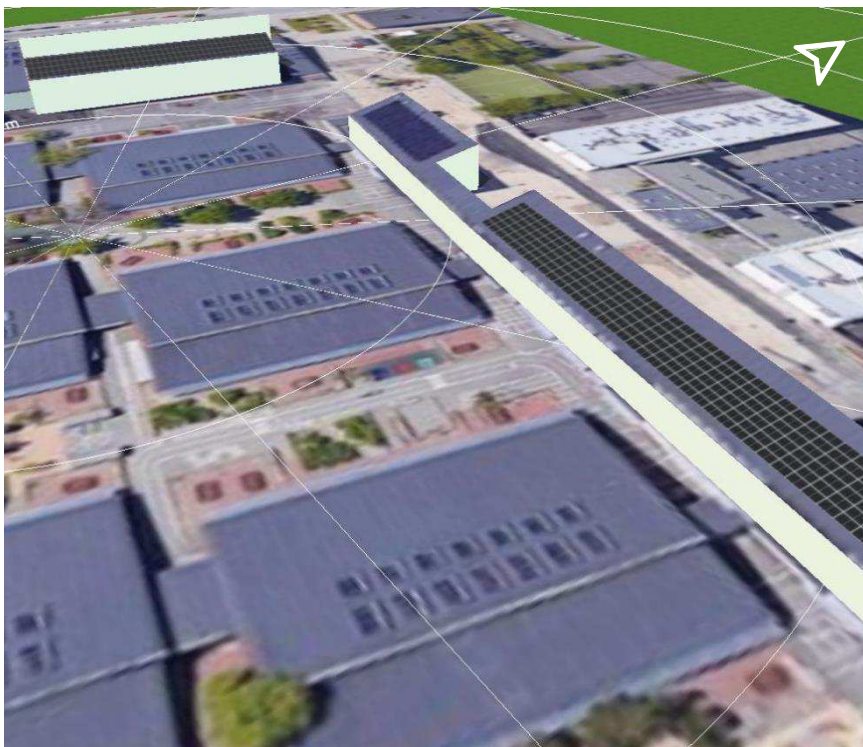
Figur 6 Modulflader med solceller. Kilde: PV*SOL-simulering
