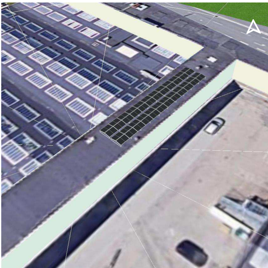
Figur 9 Modulflader med solceller. Kilde: PV*SOL-simulering
