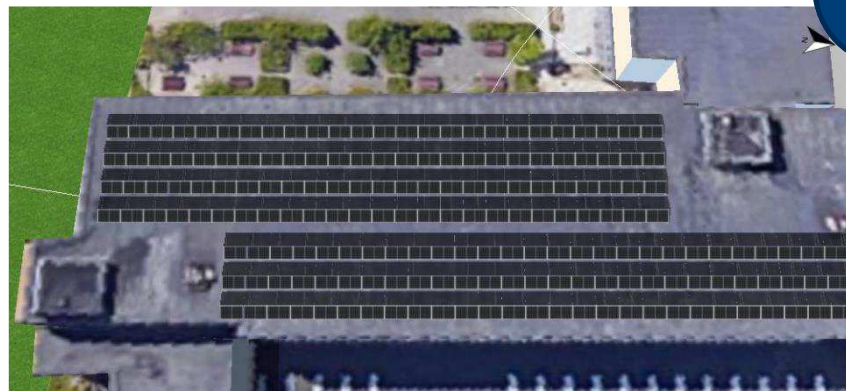
Figur 9 Modulflader med solceller. Kilde: PV*SOL-simulering
