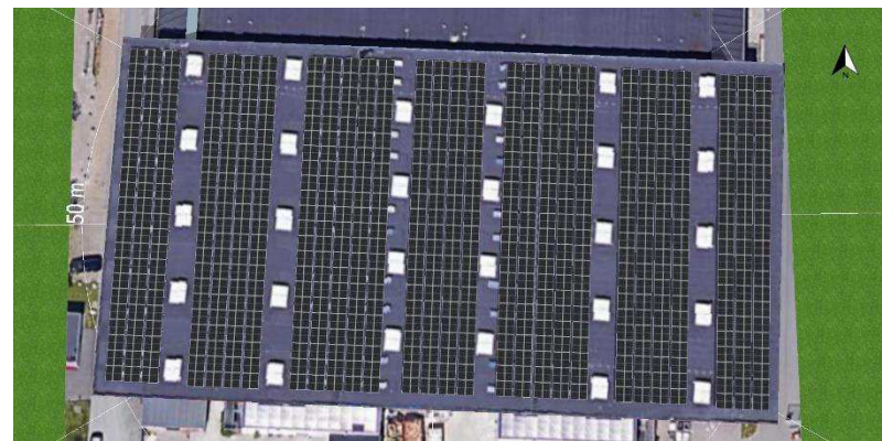
Figur 10 Modulflader med solceller. Kilde: PV*SOL-simulering
