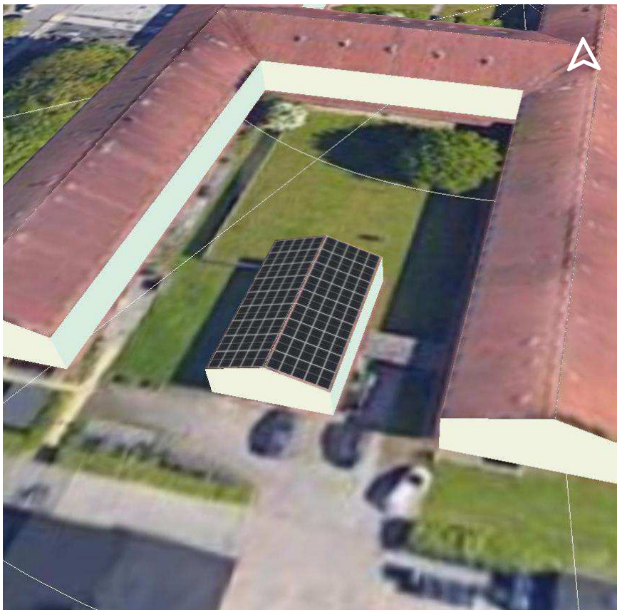
Figur 6 Modulflader med solceller. Kilde: PV*SOL-simulering
