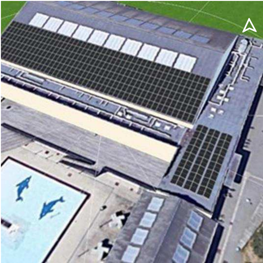
Figur 6 Modulflader med solceller. Kilde: PV*SOL-simulering
