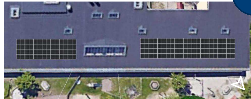
Figur 9 Modulflader med solceller. Kilde: PV*SOL-simulering
