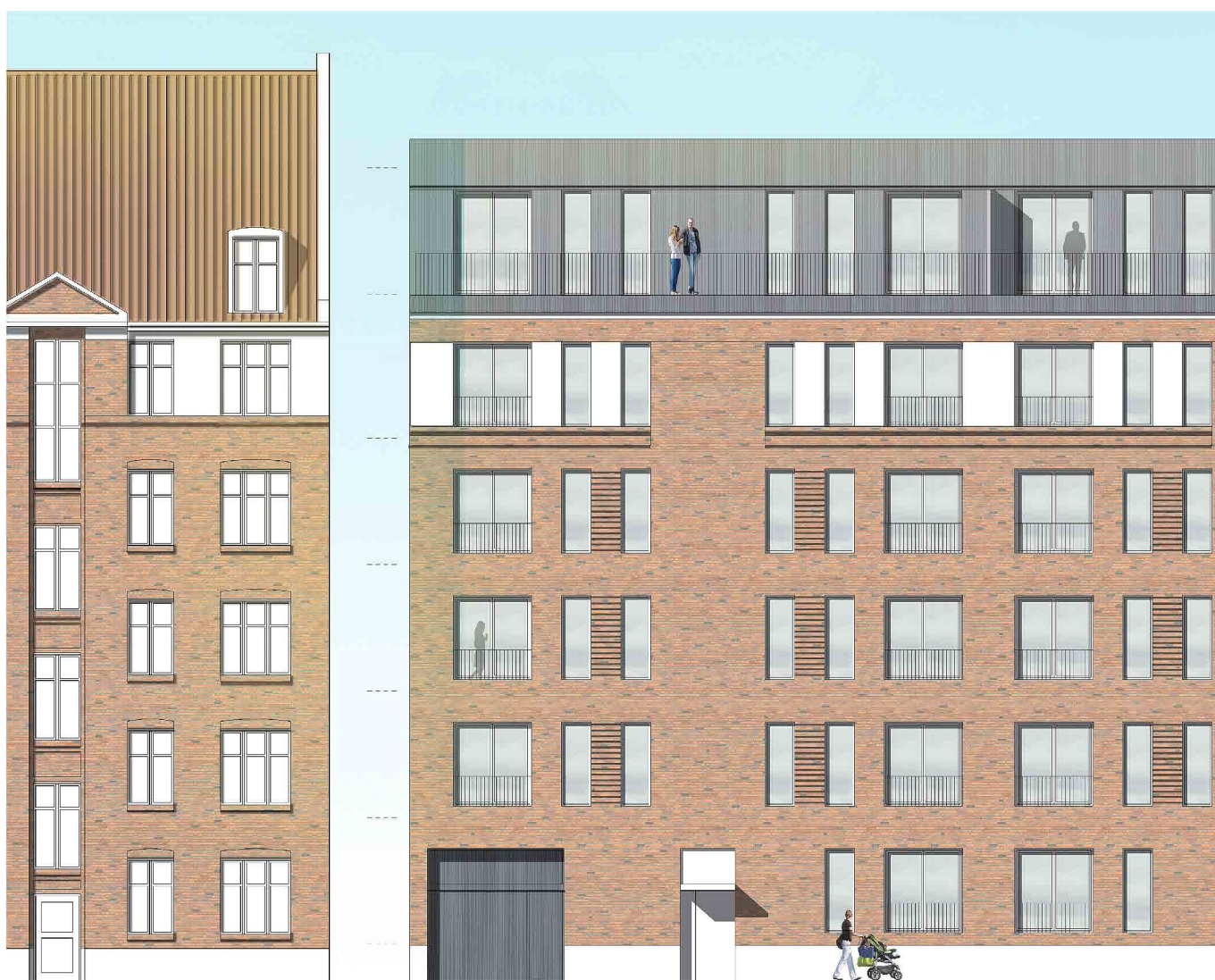
Facadeudsnit af bygning A, som ligger på den vestlige del af ejendommen, med nedkørsel til parkeringskælder. Til venstre ses den bevaringsværdige, uafsluttede nabobebyggelse. Illustration: Luplau/Poulsen Arkitekter.
