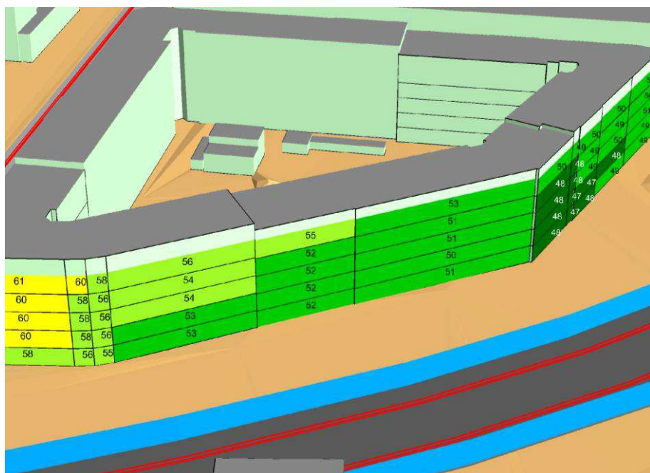
Figur 10: Beregnet støjbelastning på projektets facader, vist som L_{den} i dB. Set fra øst.
