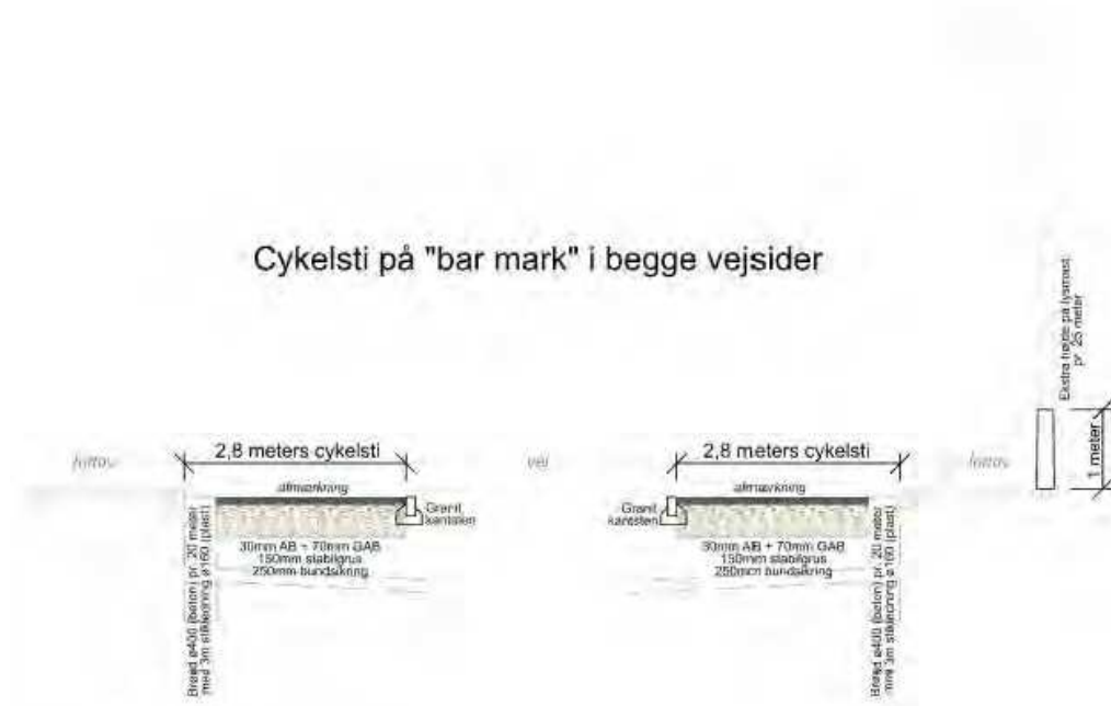
Figur 6: Principtværsnit for cykelsti langs vej i nybygget byområde
