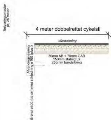
Figur 3: Principtværsnit for dobbeltrettet cykelsti på bar mark
