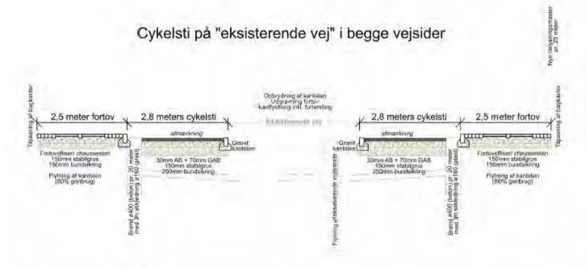
Figur 5: Principtværsnit for cykelsti langs vej i eksisterende byområde
