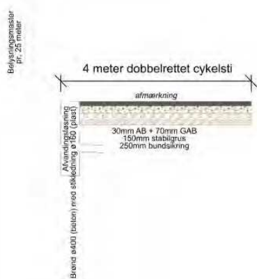
Figur 3: Principtværsnit for dobbeltrettet cykelsti på bar mark
